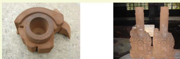
图2 用再生砂制造的汽车铸件的热芯盒砂芯
